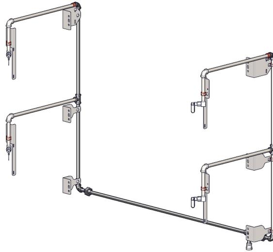
Cette conception a été testé et approuvé pour se conformer avec succès aux codes d'extinction des incendies. Il utilise seulement deux (2) buses par chambre de cuisson, et permet plateaux à miettes, carters de chaîne, et tous les autres accessoires pour être facilement enlevés. Le kit ne pas interférer avec les opérations ou l'entretien.
