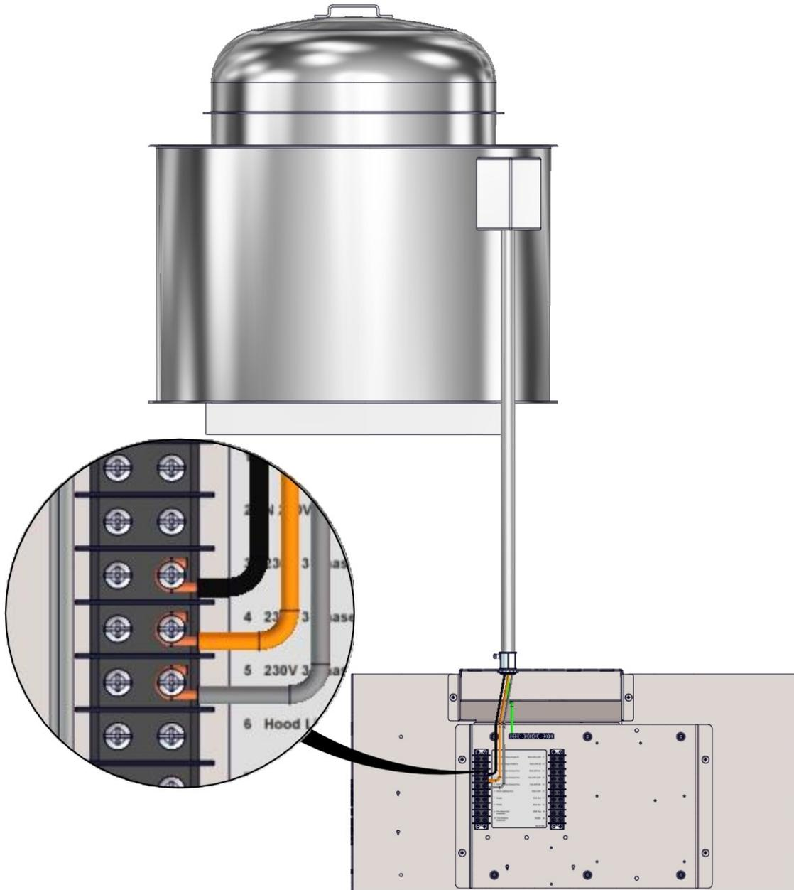
MUA Damper Relais - Single Output - Tension et fréquence
