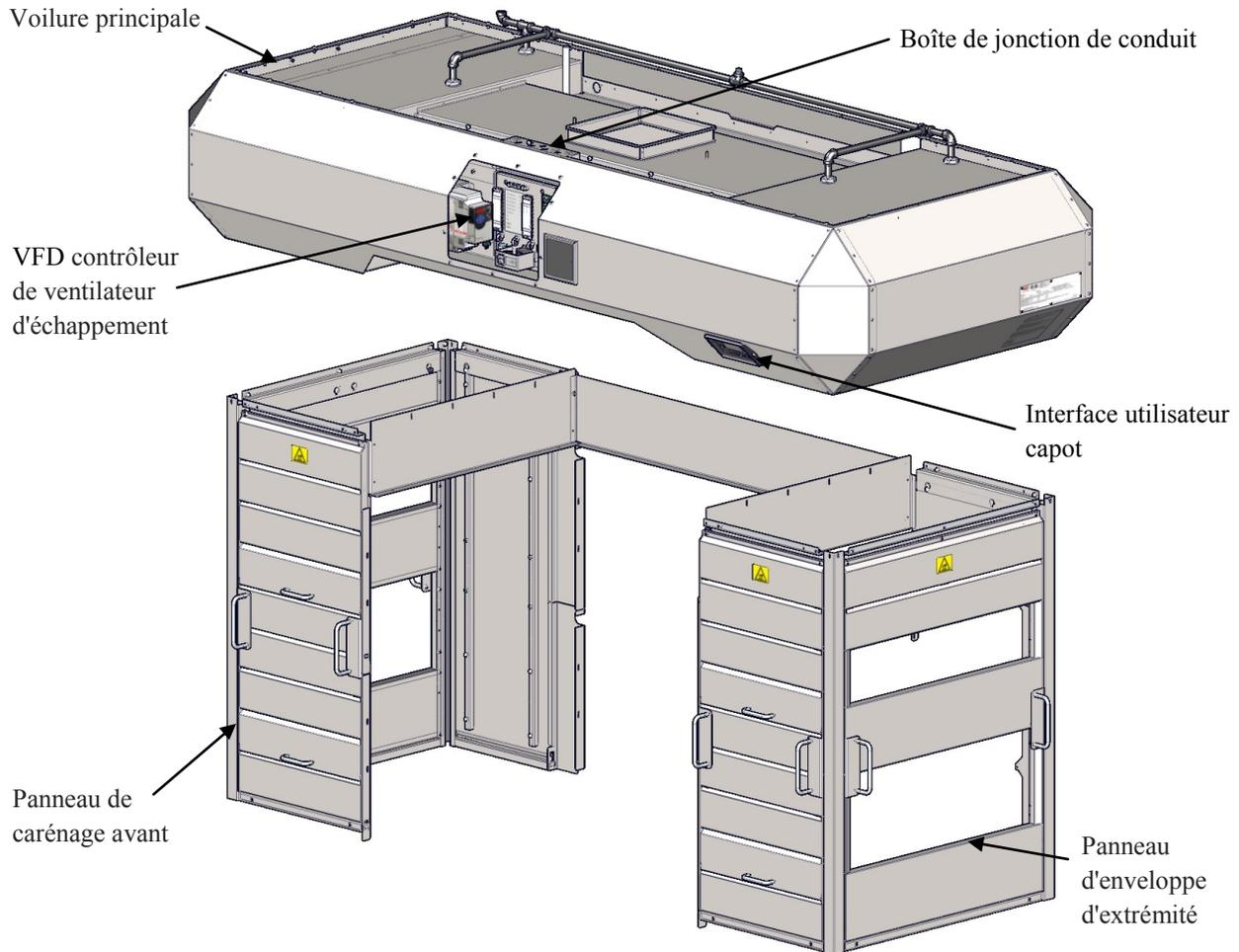
Le système de capot AVI est composé de trois (3) grandes parties; Main Canopy, le Haubans, et le variateur de fréquence (VFD) contrôleur de ventilateur d'échappement variable.
