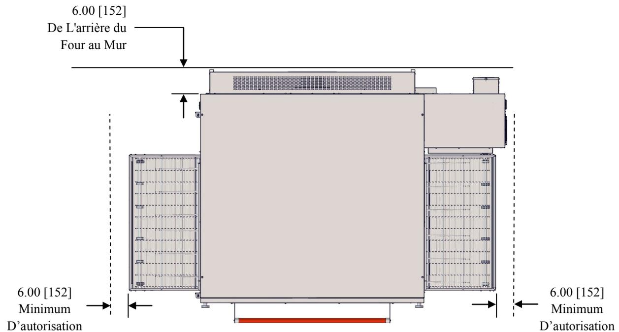
**NOTE** → Les services publics doivent être facilement accessibles lorsque les fours sont en position installée. N'installez pas d'utilitaires derrière les fours.
