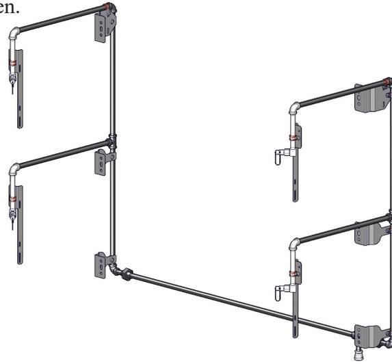
Dieser Entwurf wurde geprüft und genehmigt, um erfolgreich mit Feuerunterdrückungs Codes erfüllen. Es verwendet nur zwei (2) Düsen pro backen Kammer und ermöglicht Krümelbleche , Kettenschutz und alle anderen Zubehörteile leicht entfernt werden. Das Kit nicht mit irgendwelchen Operationen oder Wartung stören.
