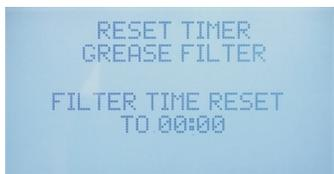
1. La alarma de reajuste del filtro del ventilador de refrigeración y la grasa se mostrará en la parte inferior izquierda de la interfaz de usuario de la capilla. Pulse el botón Información de error para entrar en la pantalla a cero.
