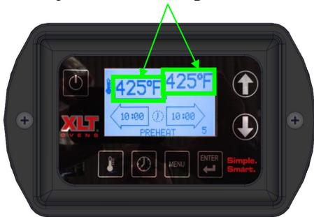
② **Ajuste de la temperatura:** Presione el botón de TEMP durante tres (3) s. Para ajustar la temperatura Utilice la flecha arriba o abajo. Si quemador doble pulse el botón TEMP el cambio a otro de temperatura. Pulse Intro para guardar.
