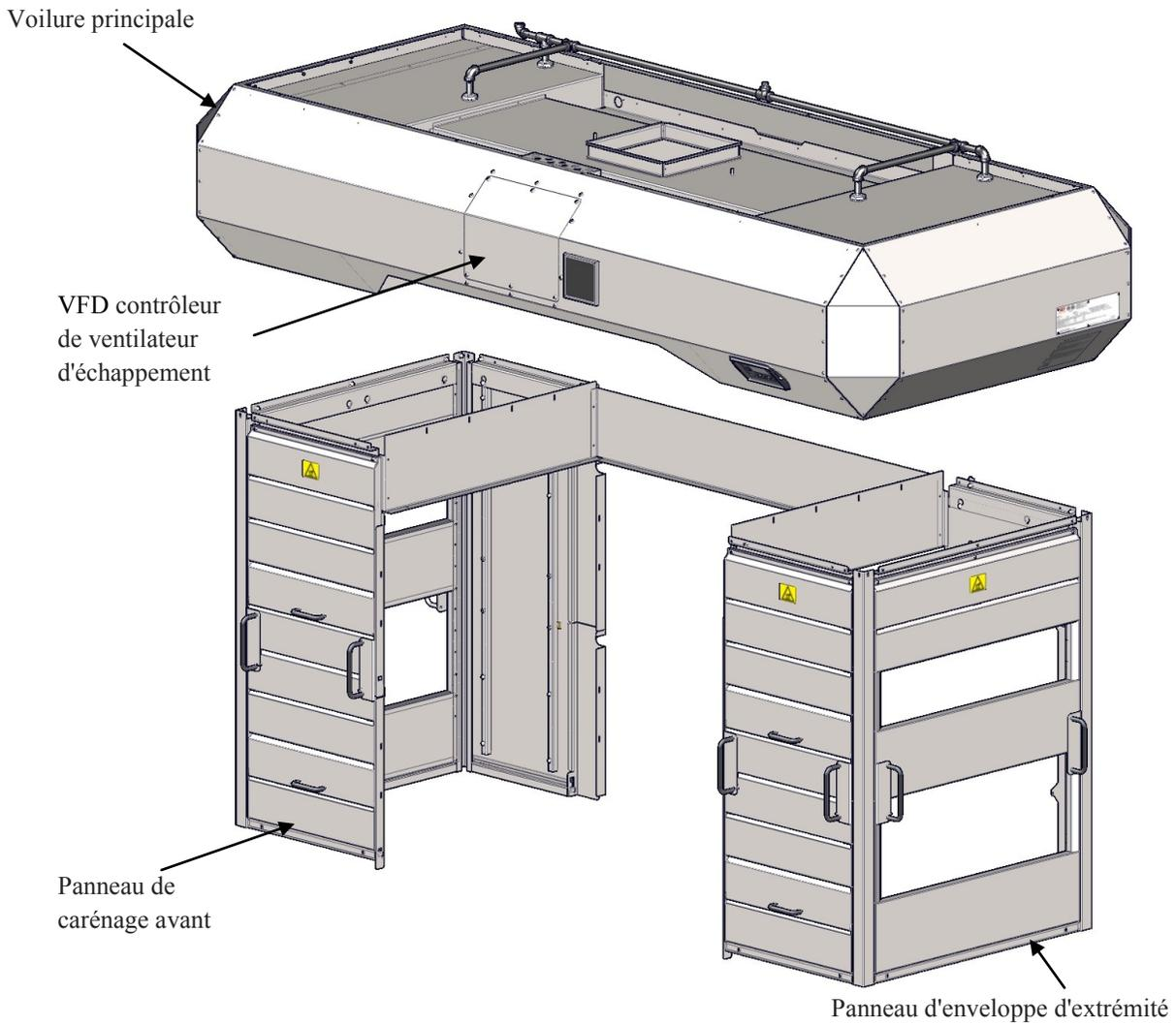
VFD Boîtier De Commande - Standard avec Suppression Du Feu
