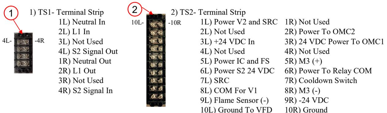
**TS 1 & 2-** Dies sind Klemmleisten , die für Drähte als Verbindungspunkt dienen.
