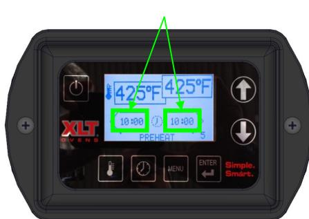
3 **Регулировка времени пояса:** Нажмите кнопку TIME в течение 3 секунд. Для регулировки времени ремня используйте стрелку ВВЕРХ или ВНИЗ. Если сплит-ремень нажимает кнопку TIME для перехода в другое время. Нажмите ENTER для сохранения.
