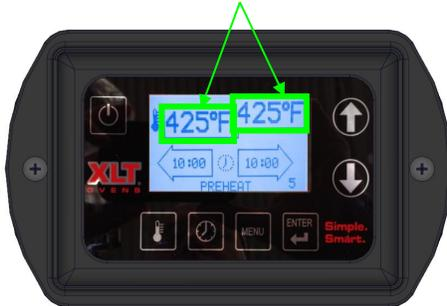
2 **Регулировка температуры:** Нажмите кнопку TEMP в течение 3 секунд. Для регулировки температуры используйте стрелку ВВЕРХ или ВНИЗ. Если двойная горелка нажимает кнопку TEMP, чтобы перейти на другую температуру. Нажмите ENTER для сохранения.
