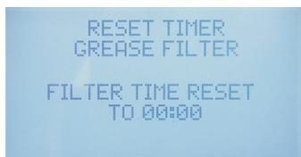
1. Сигнал сброса фильтра охлаждения и смазки будет отображаться в нижней левой части пользовательского интерфейса капот. Нажмите кнопку «Информация об ошибке», чтобы войти в экран сброса.
