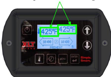
① **ANSCHALTEN:** Halten Sie die Einschalttaste eine (1) Sekunde lang gedrückt. Drücken Sie die Enter-Taste, um das Einschalten des Ofens zu bestätigen.
