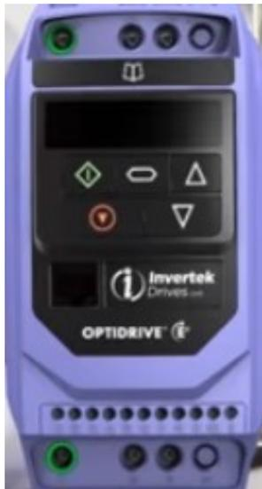
**START** Wird im Tastaturmodus verwendet, um einen gestoppten Antrieb zu starten oder die Drehrichtung umzukehren, wenn der bidirektionale Tastaturmodus aktiviert ist.
