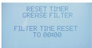
1. L'alarme Filtre de réinitialisation du ventilateur et la graisse de refroidissement sera affiché dans la partie inférieure gauche de l'interface utilisateur Hood. Appuyez sur le bouton d'information d'erreur pour entrer réinitialiser l'écran.
