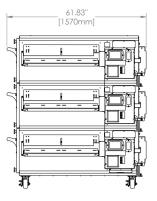
\*A MINIMUM OF A 1½" GAS SUPPLY LINE IS REQUIRED. THE GAS LINE MUST BE PLACED TO THE SIDE OF THE OVEN AND CANNOT BE BEHIND THE CONTROL BOX.
